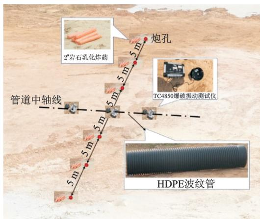
图1 现场试验设计图
