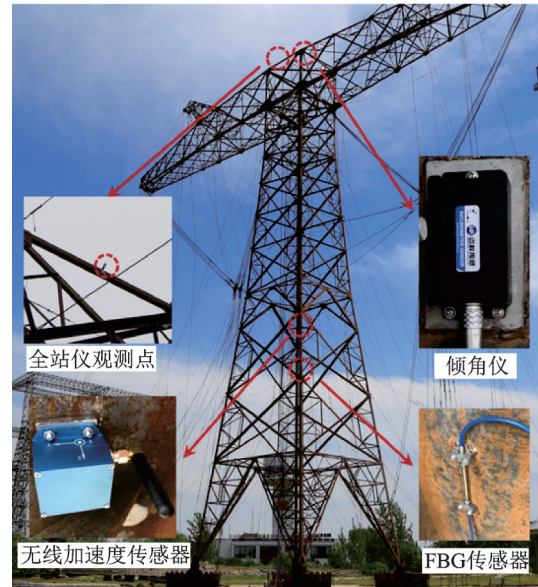
图 9 输电塔和传感器实拍图
