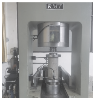
图 3 试件静力受压试验机
