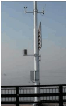
图 4 跨中桥面风速仪
