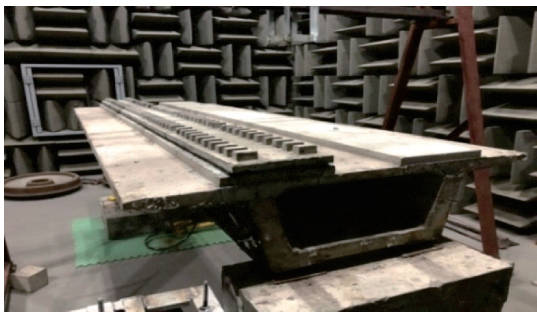
图1 轨道-箱梁模型结构
