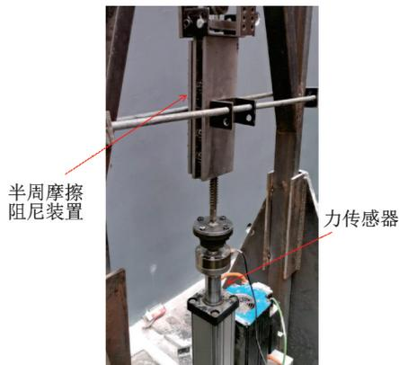
图 8 半周摩擦阻尼装置试验照片
