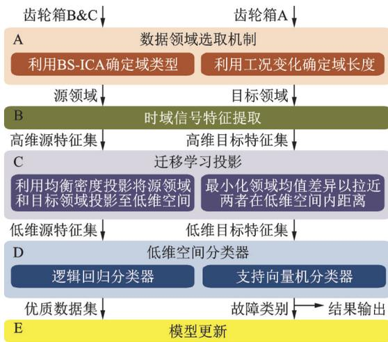
图 3 齿轮箱故障诊断模型框架
