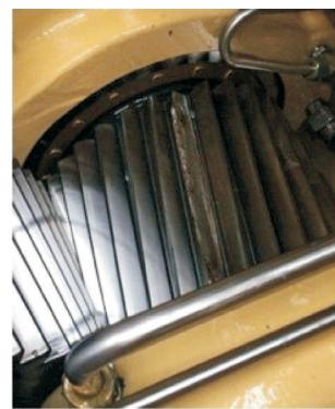
图6 轮齿断裂损伤
