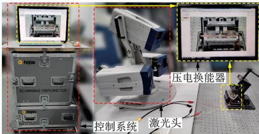
图10 振动特性测试平台
