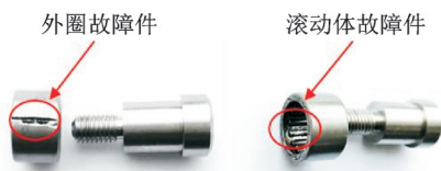
图 10 行星轮轴承故障件 Fig. 10 Planetary bearing faulty parts
