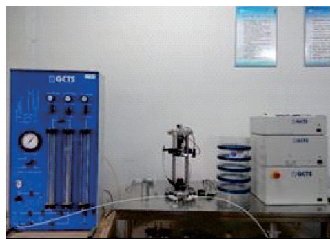
(a) GCTS共振柱试验仪TSH-100
