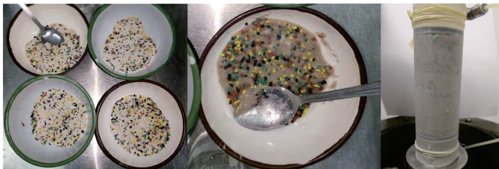
图2 橡胶-砂混合土加水拌合前后
