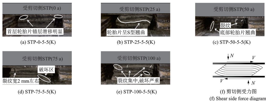
图9 剪切侧STP破坏图
