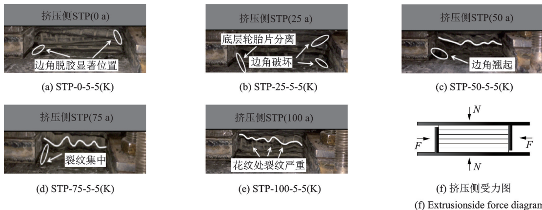
图8 挤压侧STP破坏图
