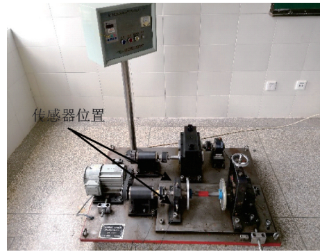
图18 QPZZ-II轴承测试平台
