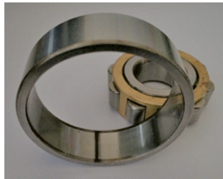
图19 轴承外圈故障
