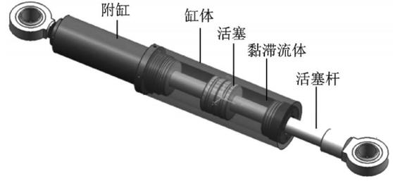
图1 筒式黏滞阻尼器构造图
