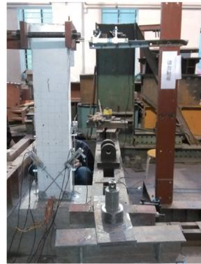
图3 加载系统及测点布置
