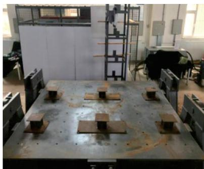
图15 隔震装置布置图
