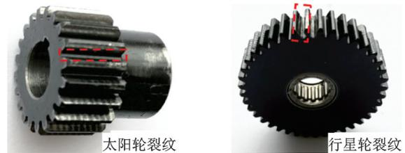
图 11 齿轮故障件
