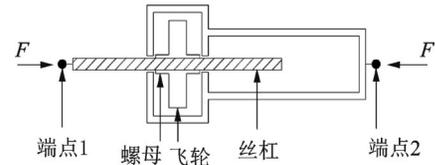
图1 滚珠丝杠惯容器原理图
