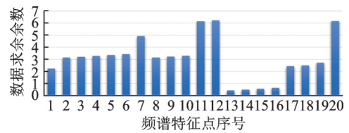
注:图17和18横轴为TOP20序号,纵轴为该序号对应频谱点频率对主轴回转频率求余后的余数。
