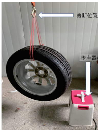
图 2 轮胎跌落噪声试验现场 Fig. 2 Tire drop noise test
