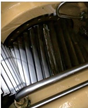
图 7 轮齿断裂损伤
