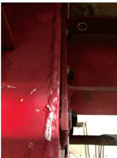
图13 梁柱节点残余变形
