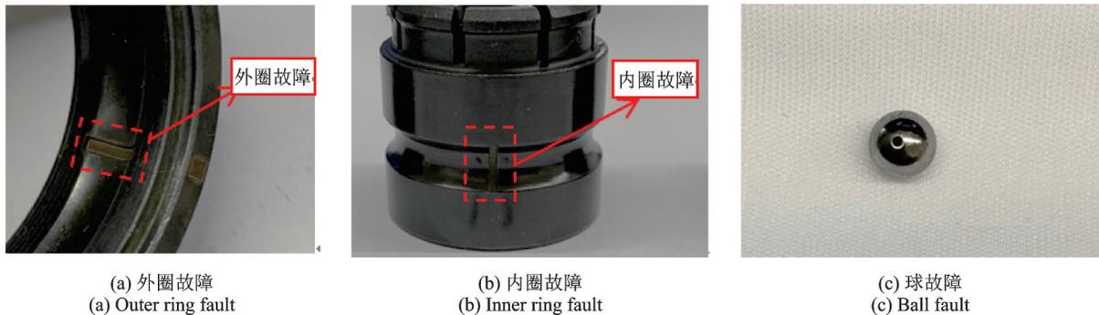
图 3 复合故障轴承缺陷部位
