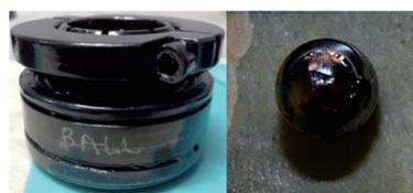
图 14 轴承滚动体故障结构图
