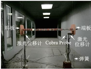
图 1 风洞中弹性悬挂模型
