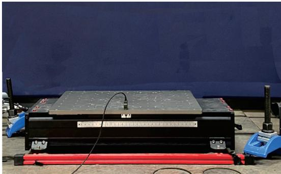
图 7 实时混合试验用振动台
