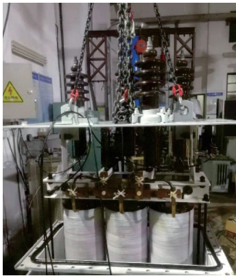
图 3 10 kV 三相电抗器模型
