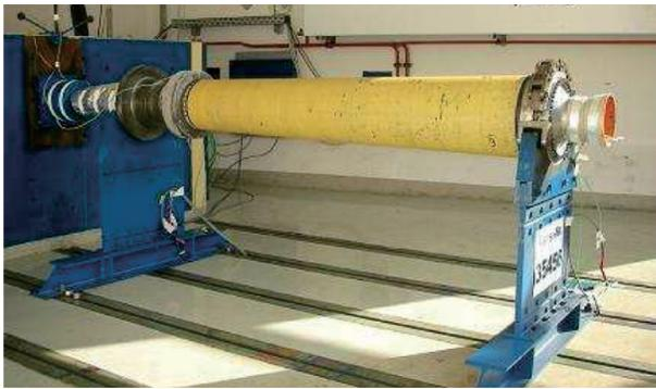
图1 固体火箭发动机地面试车试验常规固定方式<sup>[16]</sup>
