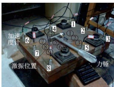
图18 锤击法试验装置
