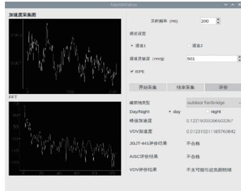
图5 振动舒适度评估系统GUI图形用户界面
