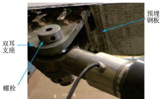
图 6 黏滞阻尼器与试件连接安装图
