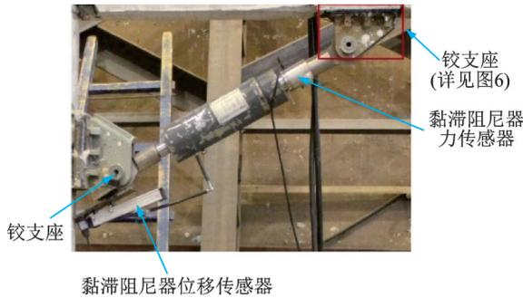
图 5 黏滞阻尼器安装图
