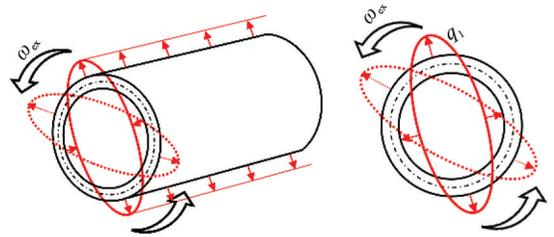
图 2 沿壳体轴向均匀分布的单频旋转行波激励示意图
