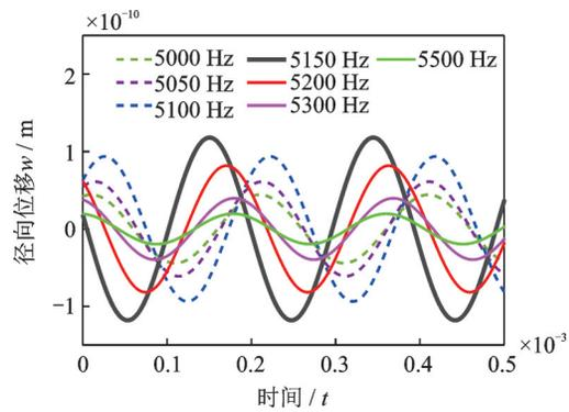
图 15 不同频率旋转行波激励下壳体响应时域图
