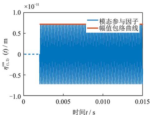
图10 旋转行波激励下壳体(1,2)阶余弦模态参与因子时变图
