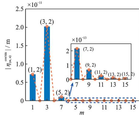
图11 旋转行波激励下壳体正、余弦模态参与因子分布图
