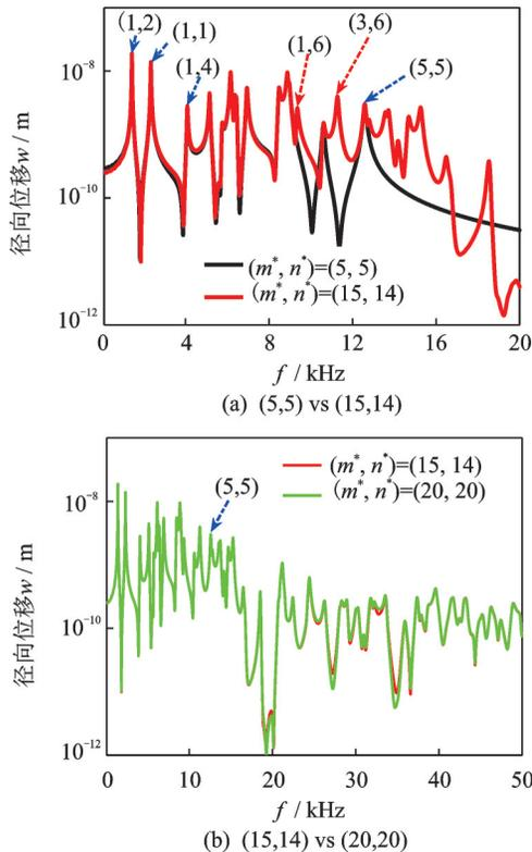
图 8 冲击激励下壳体不同截断阶次余弦模态响应频域图
