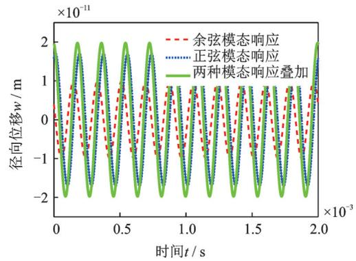
图 14 旋转行波激励下壳体正、余弦模态叠加前后响应时域图
