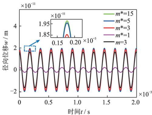
图 13 旋转行波激励下壳体不同截断阶次的响应时域图
