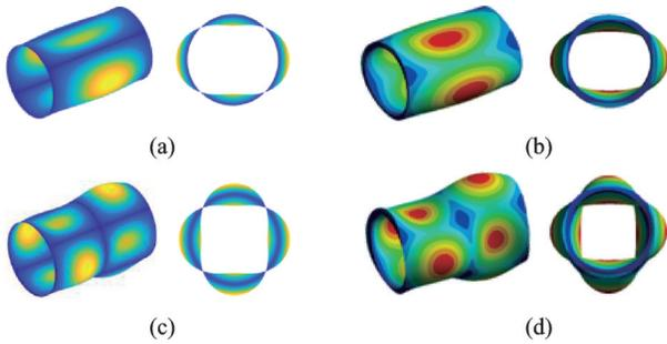
图 16 理论计算与有限元法所得壳体模态振型对比
