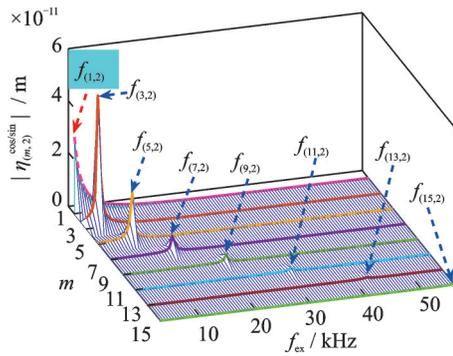
图 12 不同频率旋转行波激励下壳体正、余弦模态参与因子分布图
