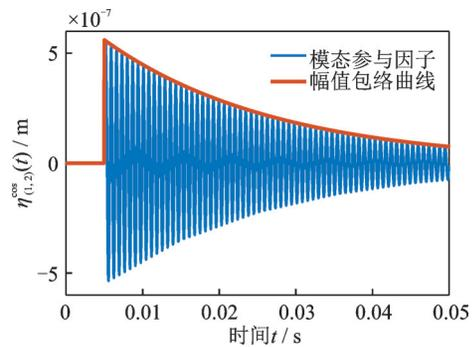
图3 冲击激励下壳体(1,2)阶余弦模态参与因子时变图
