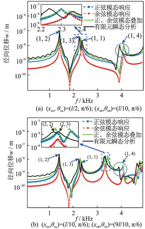
图 17 理论计算与有限元法所得壳体冲击响应对比
