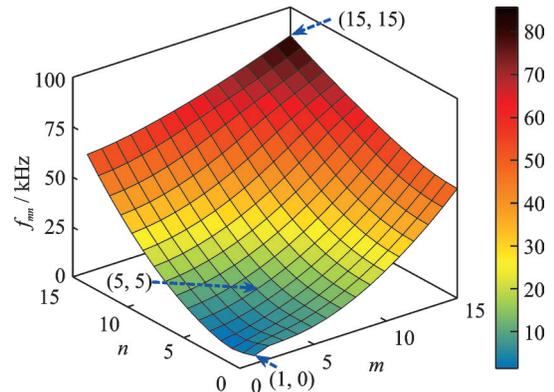
图 6 圆柱壳体模态频率分布图
