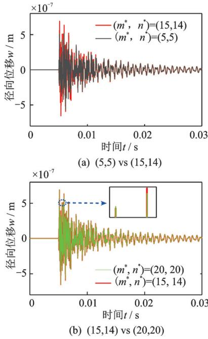
图 7 冲击激励下壳体不同截断阶次余弦模态响应时域图
