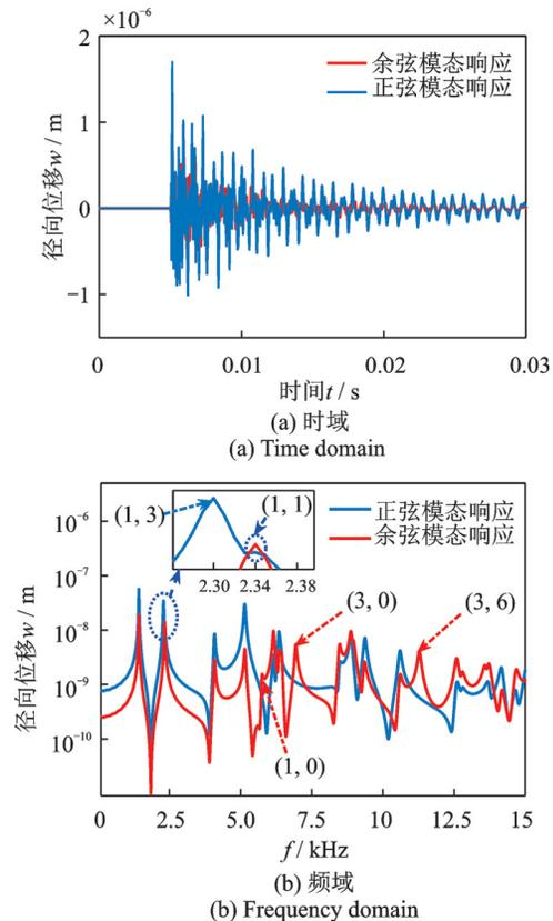
图 9 冲击激励下圆柱壳体正、余弦模态响应对比图
