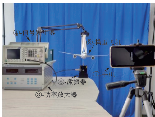
图 5 模型飞机单频振动测量的实验装置整体布局
