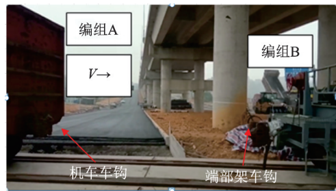
图 7 连挂冲击前 Fig. 7 Before the coupling shock
