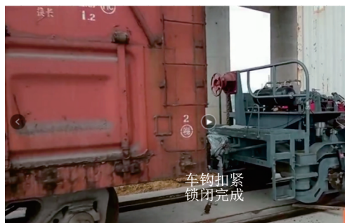
图 8 连挂冲击完成 Fig. 8 Coupling shock finished
