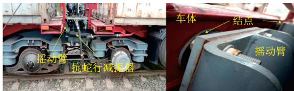
图 5 抗蛇行减振器装置 Fig. 5 The yaw damper device
