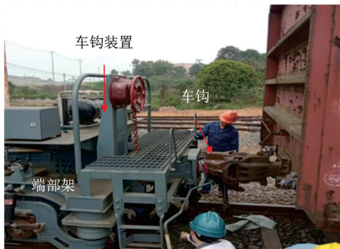
图 6 车钩装置 Fig. 6 The coupler device
