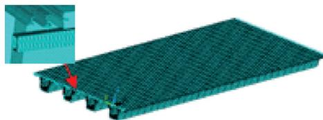
图 6 伸缩缝-桥梁有限元模型
