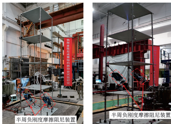
图11 半周负刚度摩擦阻尼装置振动台布置方案
