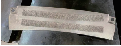
图14 贴有金属橡胶的加强筋
