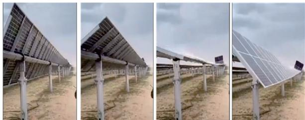
图1 平单轴光伏支架扭转气动失稳
