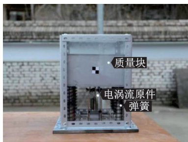
图12 TMD减振装置
