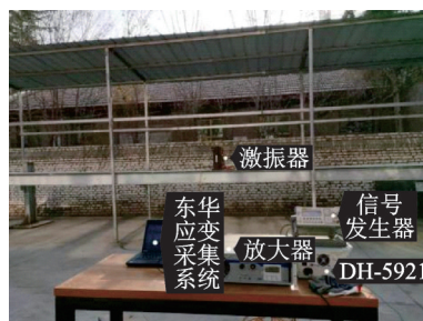
图 8 APS400 电子激振器激励
