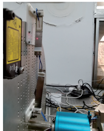
图 9 时变势阱磁耦合双稳态能量俘获系统
