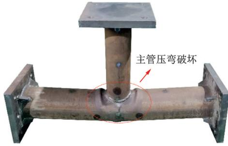
图4 试件破坏形态
