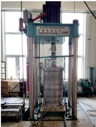
图1 WYS-2000大型多功能动静三轴试验机
