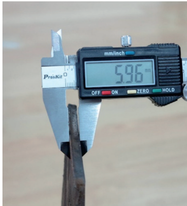
(d) 轨道垫板使用后的厚度 (d) Thickness of track pad after use
