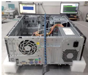
图 8 随机振动试验图
