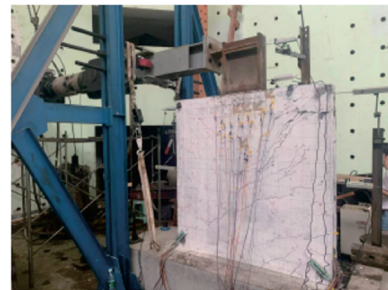
(b) 悬臂墙试验装置
