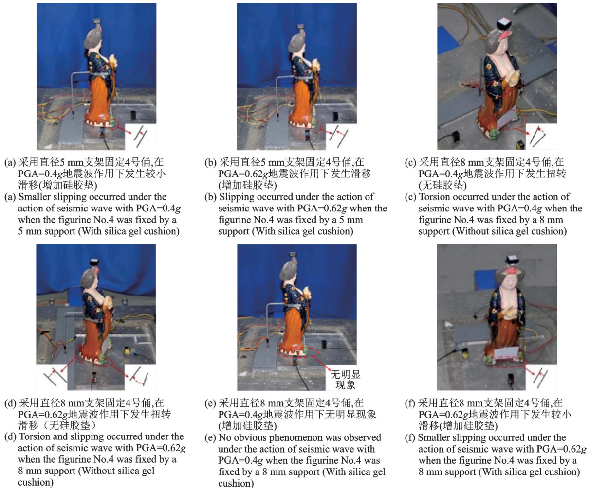
图 13 支架固定4号唐三彩人物俑复制品在No.2地震波作用下的运动状态(对比增加硅胶垫效果)
