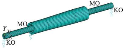
图 5 双转子-轴承系统有限元模型
