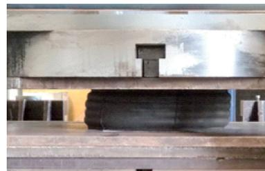
图 8 试验加载过程中支座的变形情况
