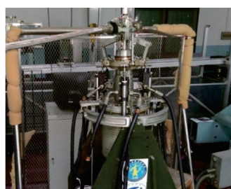
(a) 直升机主旋翼旋转试验台 [131]
