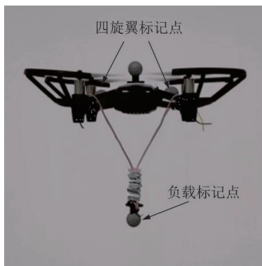
图10 TELLO 四绳吊挂运输系统
